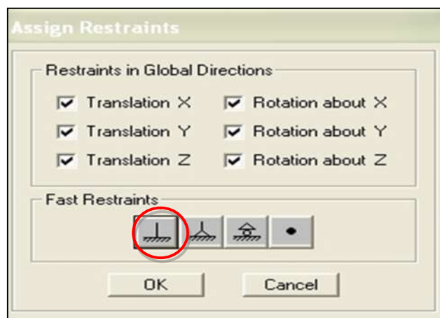
Figure 3.15 : Encastrement des poteaux.
