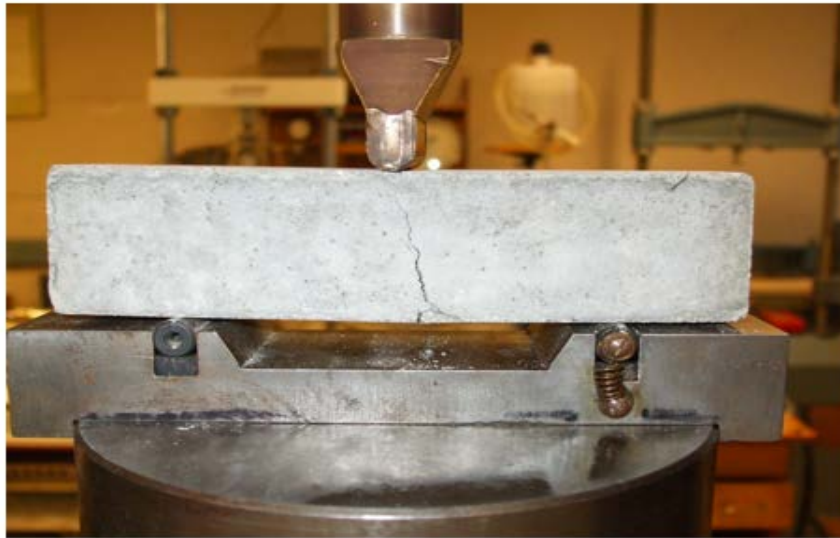
Figure III.5: Éprouvette soumise à la flexion 3 points.
