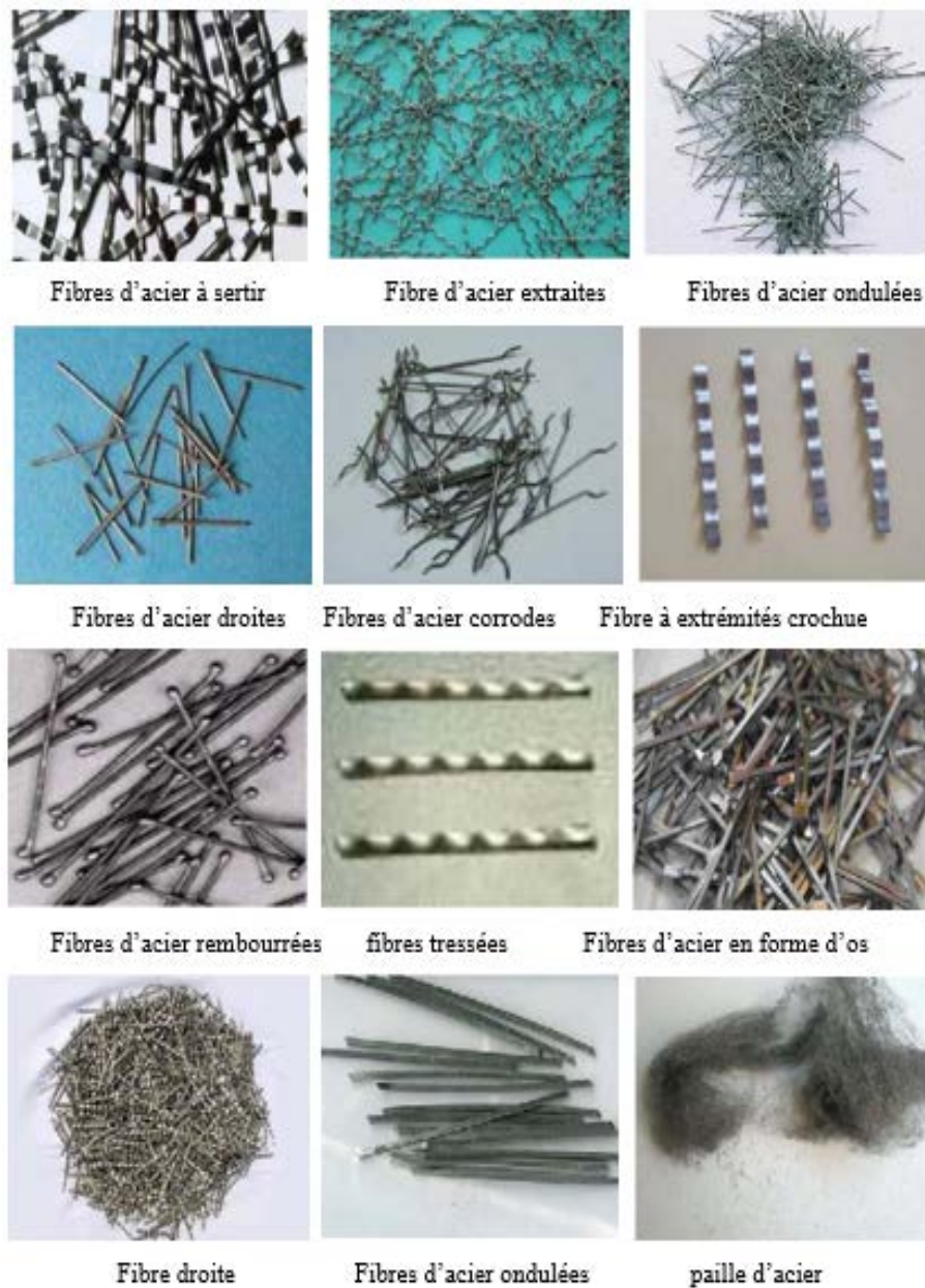
Figure I.8 : Les différents types de fibre d'acier[5].
