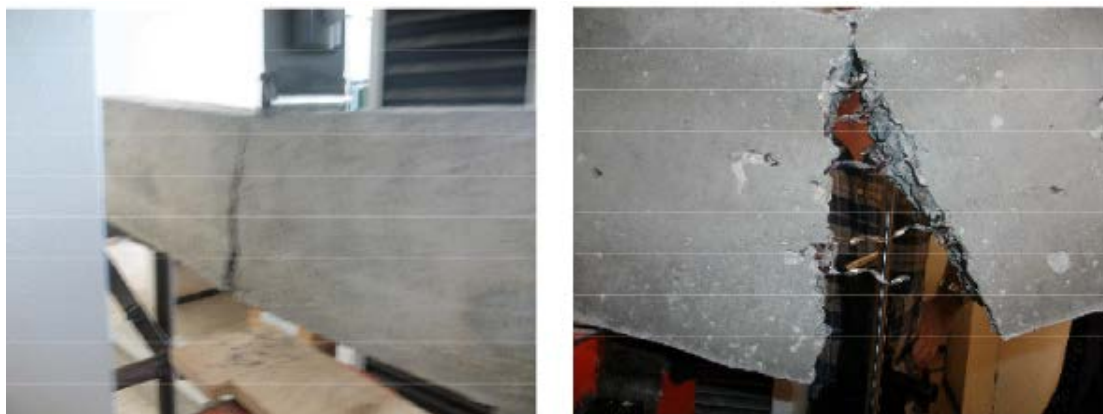
Figure I .32 : Exemple de mode de rupture des poutres lors de la flexion 3-points [7].
