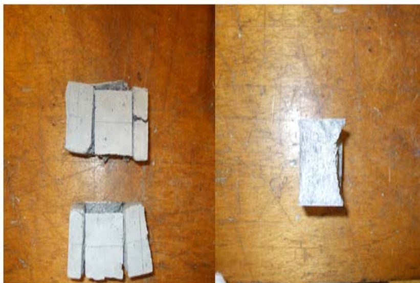
Figure III.4 : Etat de l'éprouvette après la rupture en compression.
