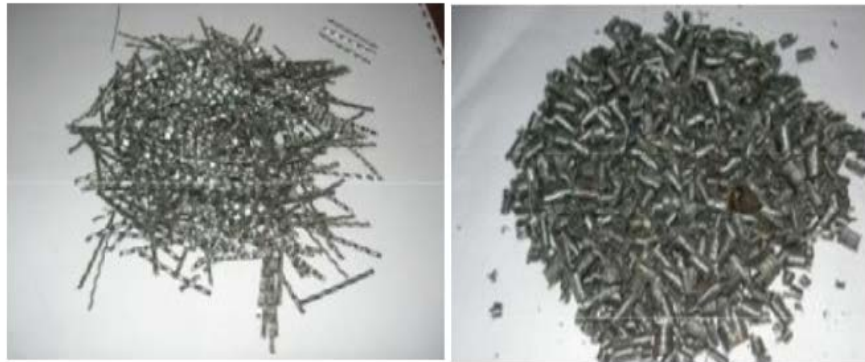
Figure I.22 Fibres industrielles FI50 et copeaux industriels SP50 [17].
