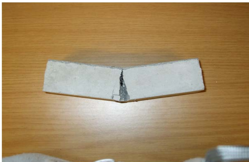
Figure III.6 : Etat de l'éprouvette après la rupture en flexion.
