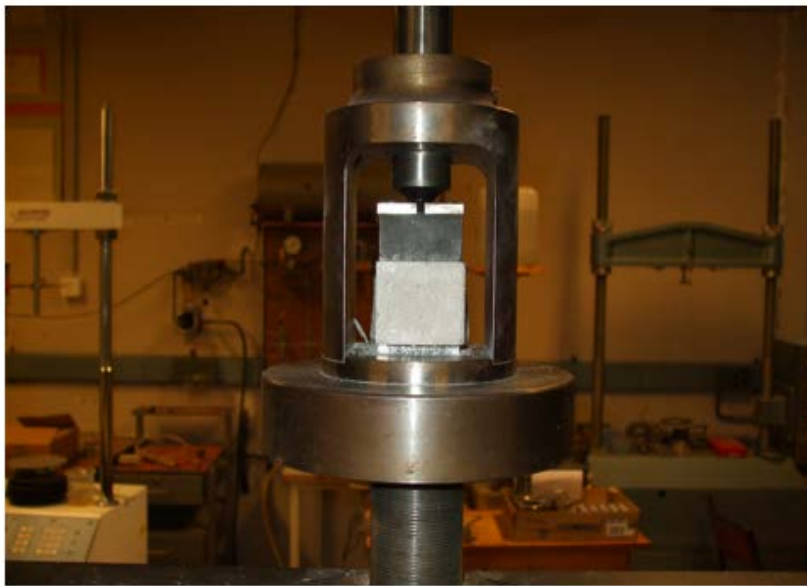
Figure III.3 : Éprouvette soumise à la compression.
