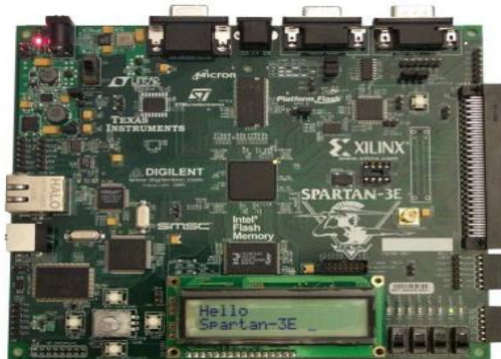
Figure 4.16. Photographie de la carte de développement FPGA (Spartan-3E XC3S500E)
