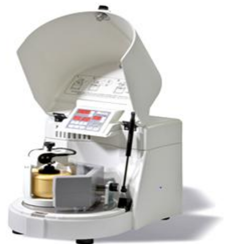
Figure II.2. Broyeur planétaire Pulverisette 6 et l'action des billes pendant le processus.
