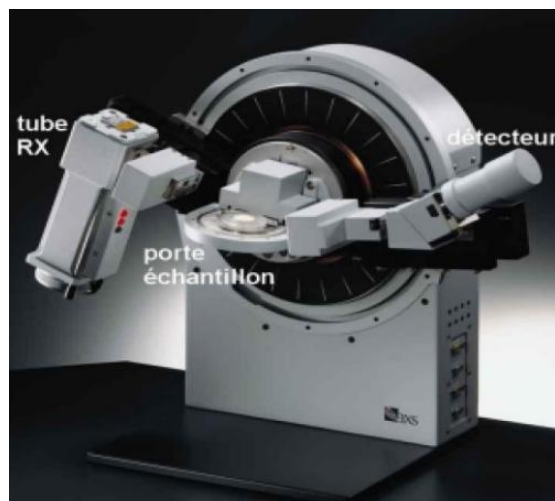
Figure III.11. Photographie du goniomètre du diffractomètre de marque Bruker-AXSD8.
