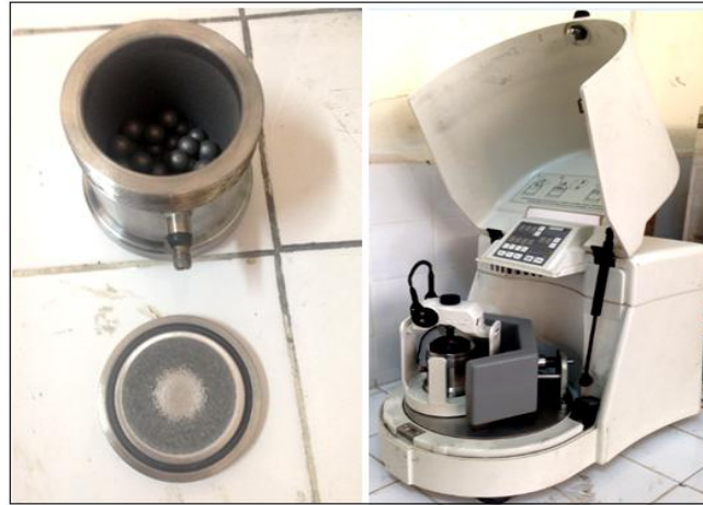
Figure III.4. Photographies de la jarre et du broyeur planétaire Pulverisette 6 utilisés.
