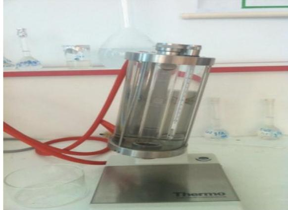
Photo III: Photo d'un viscosimètre à bille
