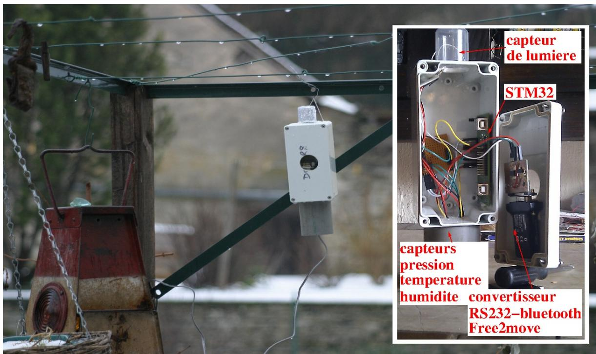
Figure IV.1 : Vue intérieure d'une station et installation en extérieur
