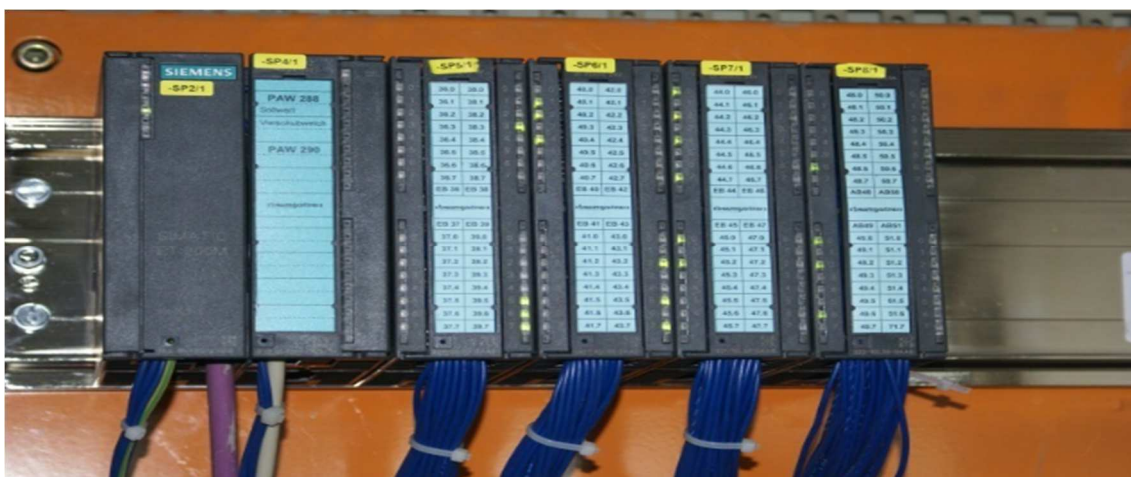
Figure III.8 : ET 200 M configurée avec 4 modules
