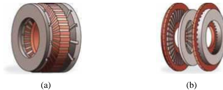
Fig.I.3. Vue schématique des machines : (a) flux radial, (b) flux axial.
