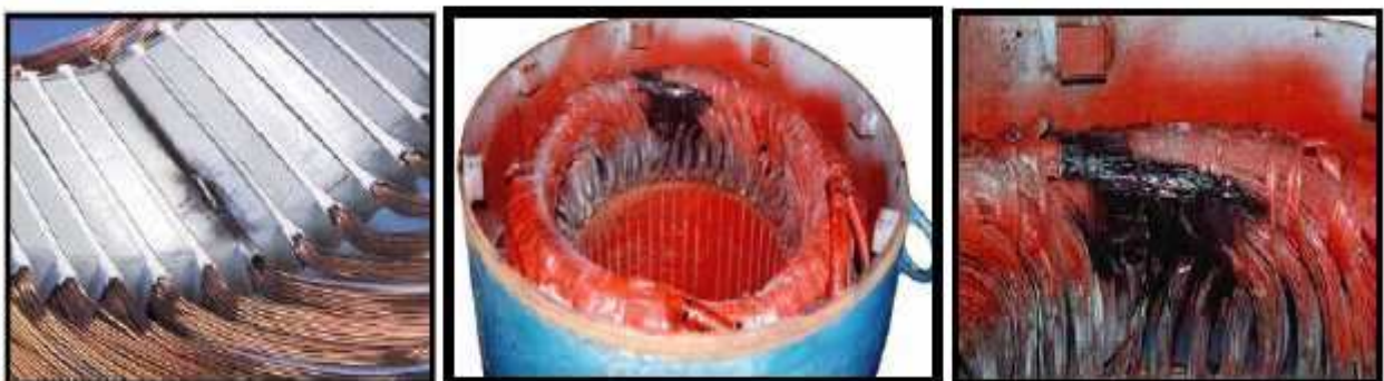
Fig.I.7. Exemple de dégâts provoqués par les défauts de court-circuit statoriques [1].
