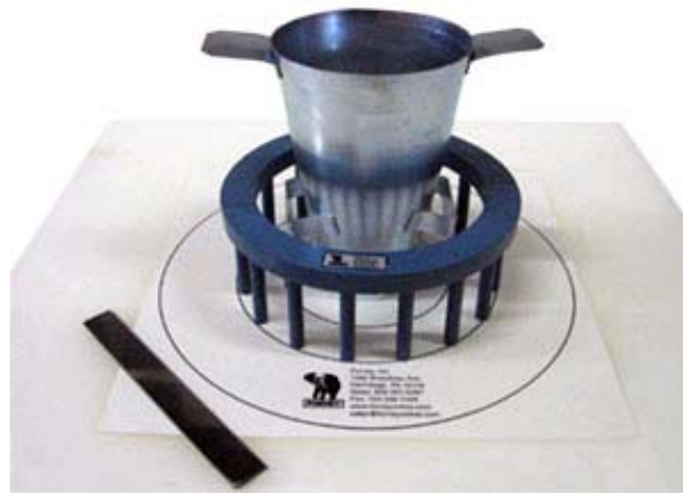
Figure II.13 : schématisation de l'essai de J-Ring
