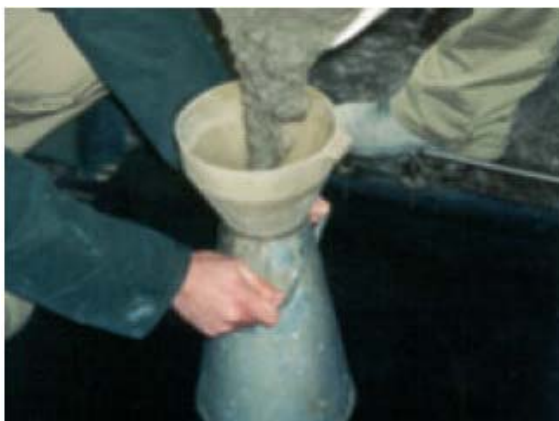
Figure II.10 : dispositif d'essai de mesure de la fluidité du béton : le cône d'Abrams.
