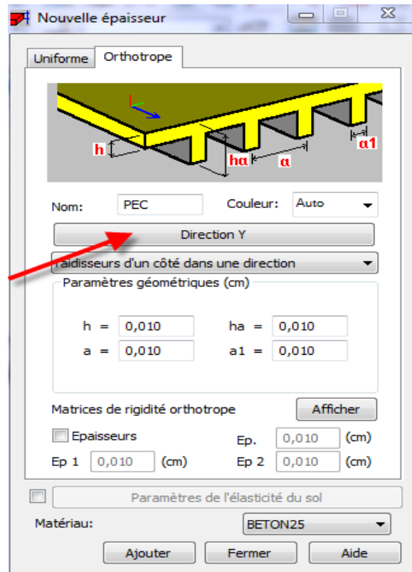
Figure IV.7 Définition d'un plancher à corps creux.
