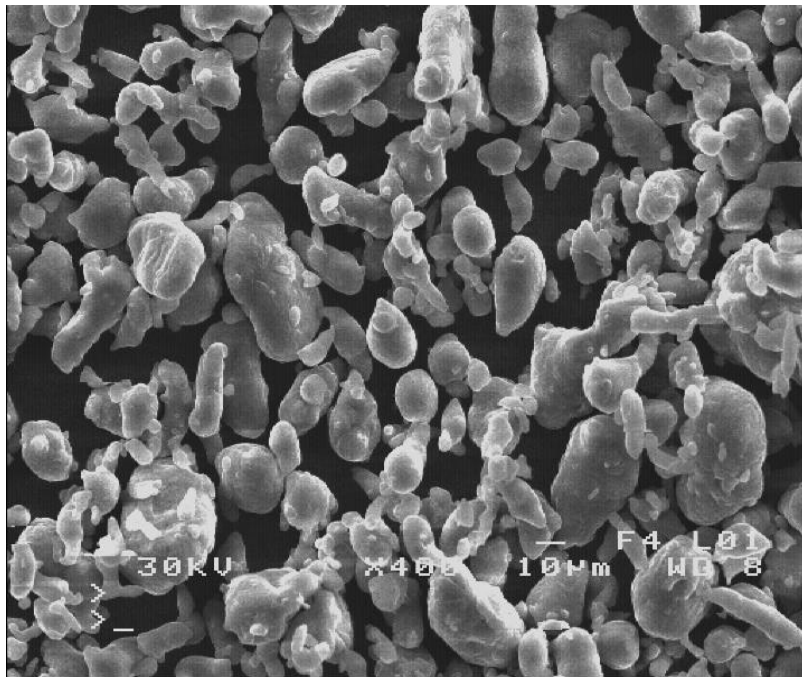
Photo 3. Aspect des grains de la poudre d'aluminium pur.
