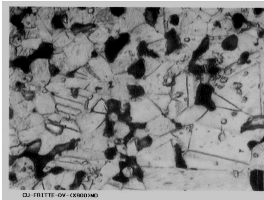
Photo 4 : Micrographie optique du cuivre pur fritté à 1000°C (après attaque chimique).
