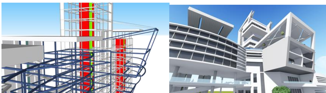
Fig 12 - 13 : les poteaux inclinés.
