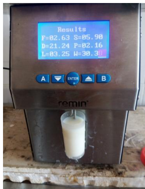
Figure 08 : Photo originale d'un lactoscane « spectrophotomètre » (original ,2018).
