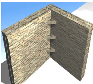
Figure IV- : Renforcement par des briques, liaison commune aux deux murs.
