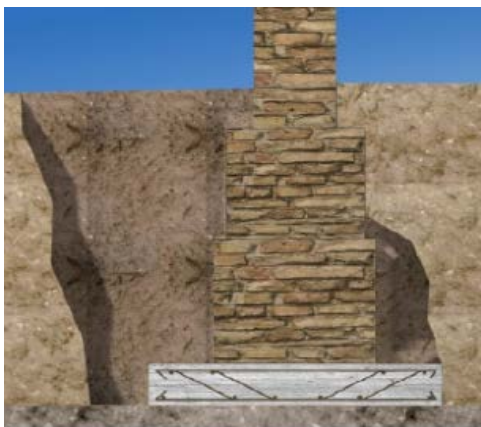
Figure IV- : Stabilisation du mur par élargissement de la semelle après étaieement
