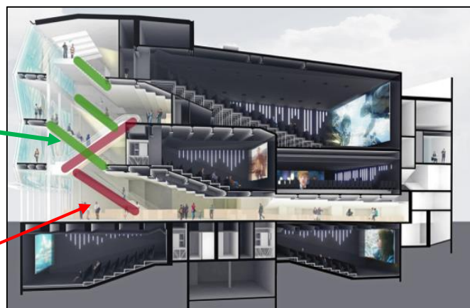
Figure 144: coupe verticale d'Alésia cinéma illustre le principe de circulation intérieure verticale.
