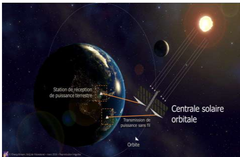
Figure I.29: Schéma de fonctionnement d'une centrale solaire orbitale [41].
