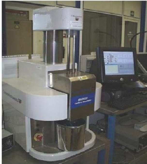
Figure II.22 : Rhéomètre capillaire
