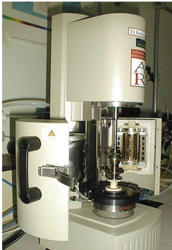
**Figure II.20 :** Image d'un Rhéomètre dynamique
