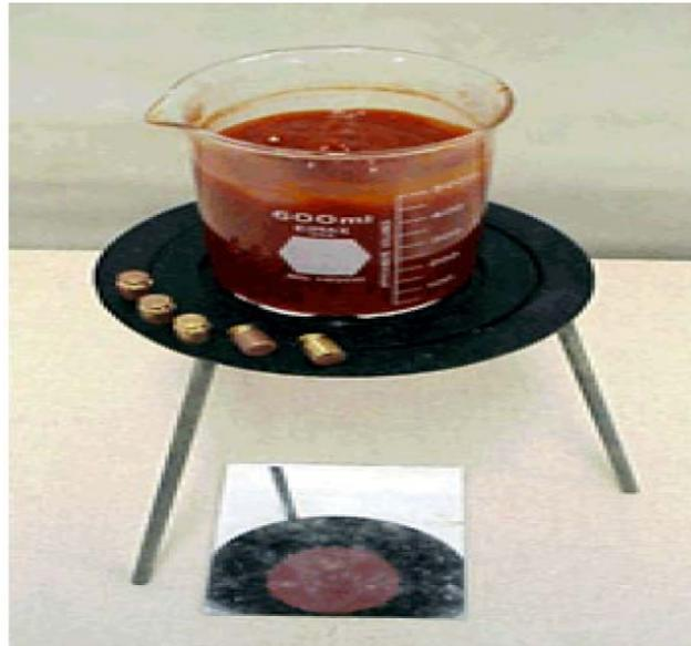
**Figure II.14 :** Protocole expérimental de la mise en évidence du caractère thixotrope du ketchup.
