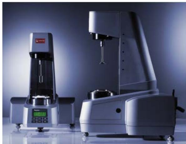
Rhéomètre à cylindre et de type cône-plan (de gauche à droite) : en viscosimétrie, la géométrie supérieure tourne de manière continue (rotation) ; en viscoélasticité, elle oscille.
