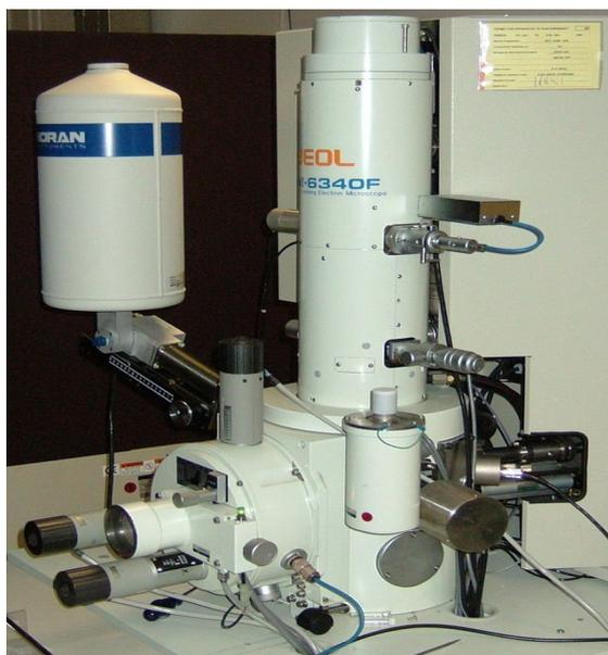
**Figure IV.5 :** Microscope électronique a Balayage
