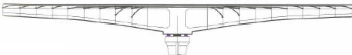
**Fig.I.8 : Mise en place de la précontrainte de fléau en fibre supérieure.**
