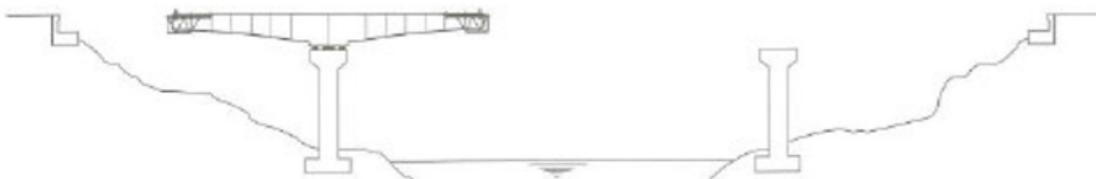
Fig.I.6 : Construction des fléaux-structure isostatique
