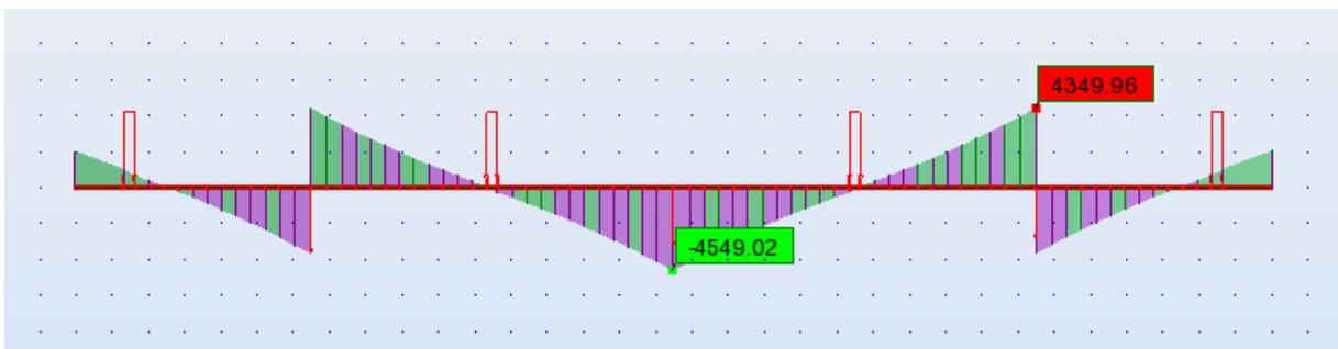
Fig. VII.15: Diagramme des efforts tranchants après enlèvement de l'équipage de clavage [t].
