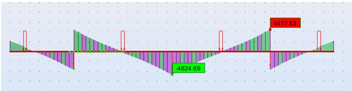
Fig.VII.12 : Diagramme des efforts tranchants avant enlèvement de l'équipage de clavage [t].
