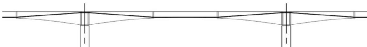
Fig.I.10 : Mise en place de la précontrainte extérieure
