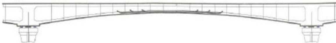
Fig.I.9 : Mise en place des éclisses de précontrainte en partie inférieure
