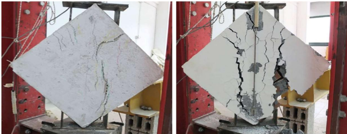
Figure III.10 : Distribution des dommages et des fissures dans les éléments modélisés
