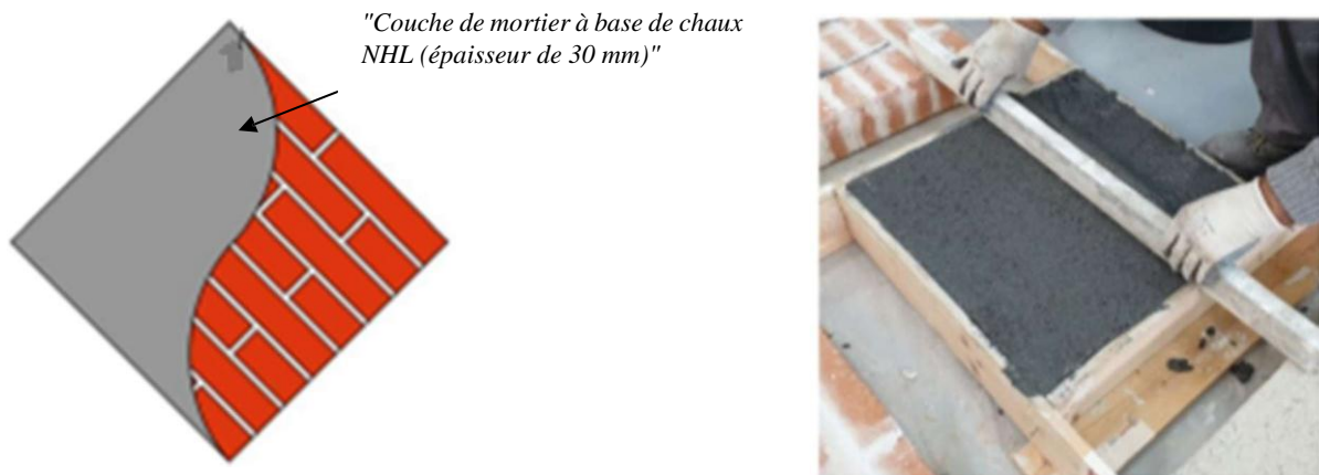
Figure II.2. Conception du mur en brique renforcé par une matrice NHL expérimenté par Longo et al (2021) (4)
