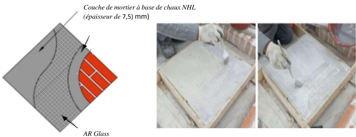
Figure II.3. Conception du mur en brique renforcé par une matrice NHL et un tissu en verre AR expérimenté par Longo et al (2021) (4)
