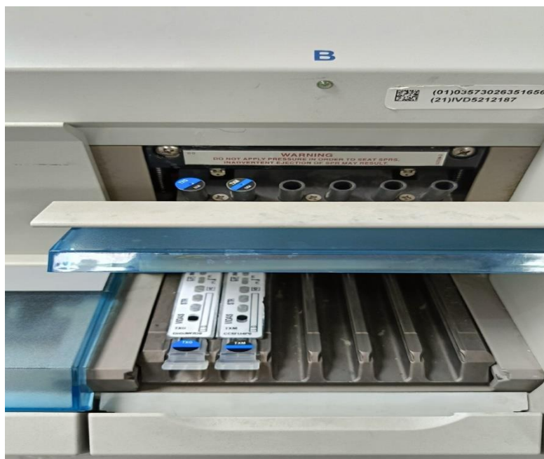
Figure 20 : cônes et cartouches TXG et TXM utilisés par VIDAS (Originelle, 2025)
