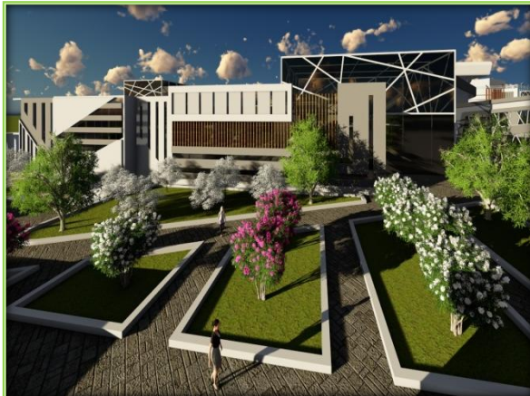
Figure 174: Utilisation des brises soleil verticaux du coté est, pour protéger le bâtiment du soleil en été . Source: Auteurs
