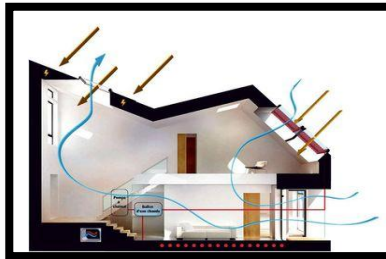
Les systèmes de rafraîchissement par ventilation naturelle.
