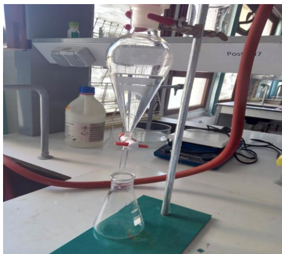
Figure7: Separation de l'huile essentielles de l'éther
