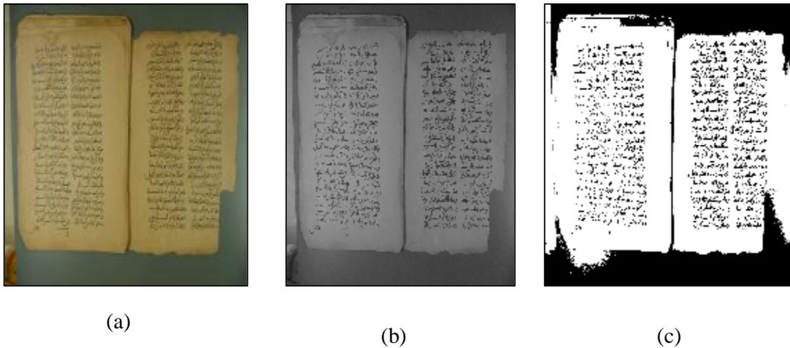
**Figure 2:** (a) : Image originale, (b) : Image en niveau de gris, (c) : Image binarisée
