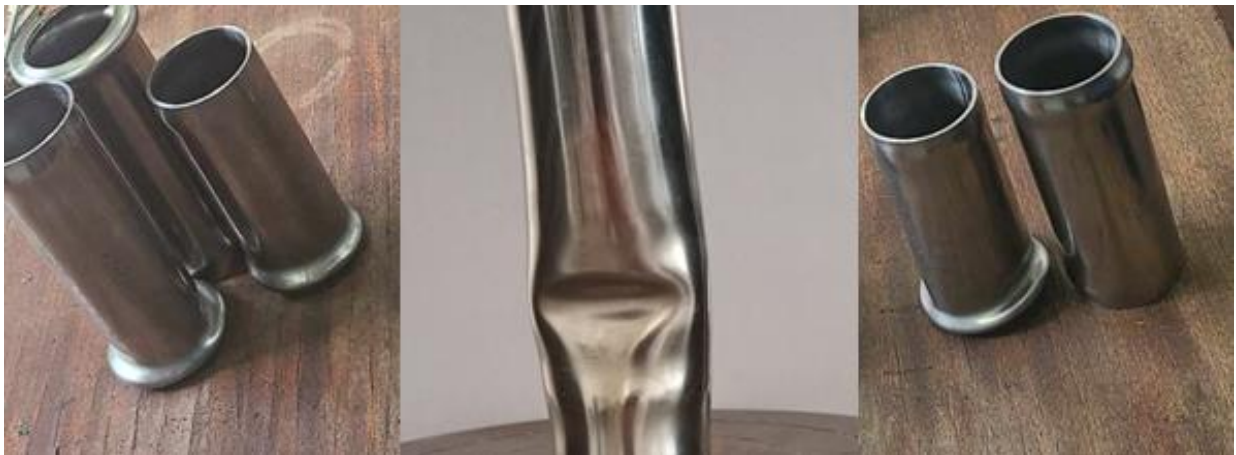
Figure II.21: Les échantillons après l'essai de compression.
