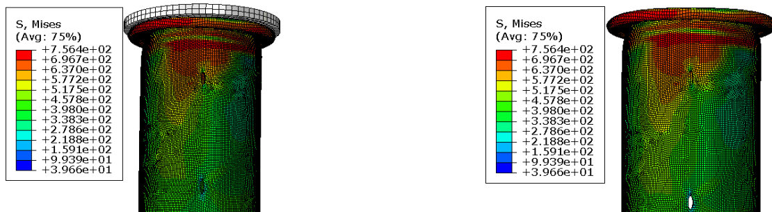
Figure III.31: Contour des contraintes de Von mises sur l'éprouvette8 ellipses après le chargement axial.
