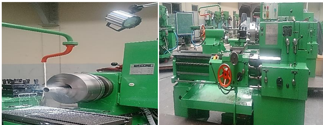
Figure II.19 : dressage des surfaces brutes à l'aide d'un tour.
