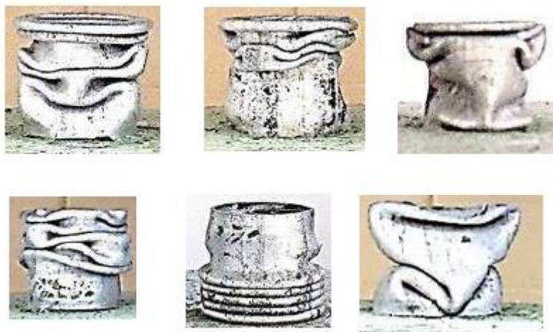
Figure I.16 : Diverses méthodes de déformation des structures tubulaires soumises à un écrasement axial [19]
