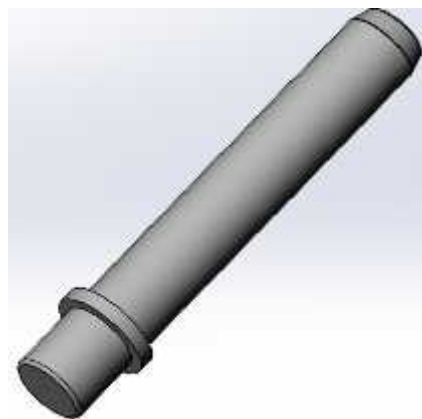
Figure IV. 11 : Colonne de guidage.
