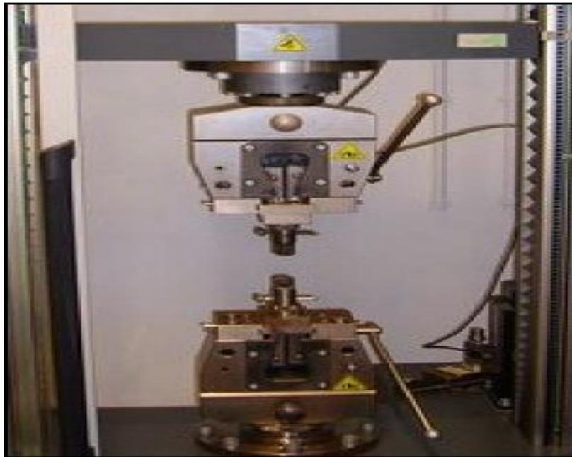
**Figure III.14.** Dispositif utilisé pour les essais d'allongement à la rupture et de résistance à la traction.
