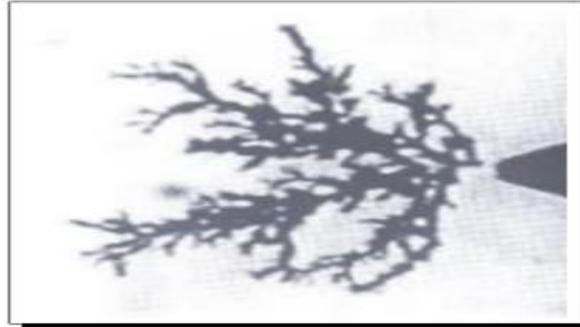
**Figure I.5.** Exemple d'une arborescence électrique [24].
