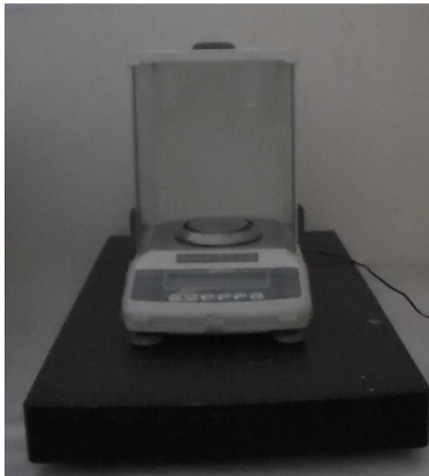
**Figure III.15.** Balance utilisée pour la mesure de la perte de masse et de l'absorption d'eau.
