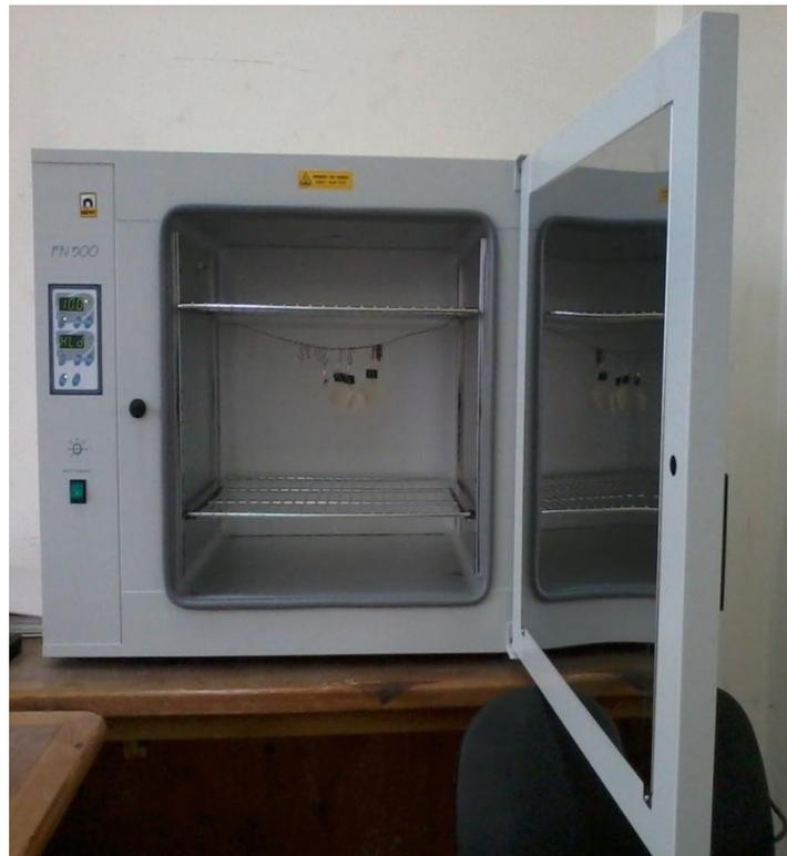
**Figure III.6.** Vue de l'étuve utilisée pour le vieillissement thermique.
