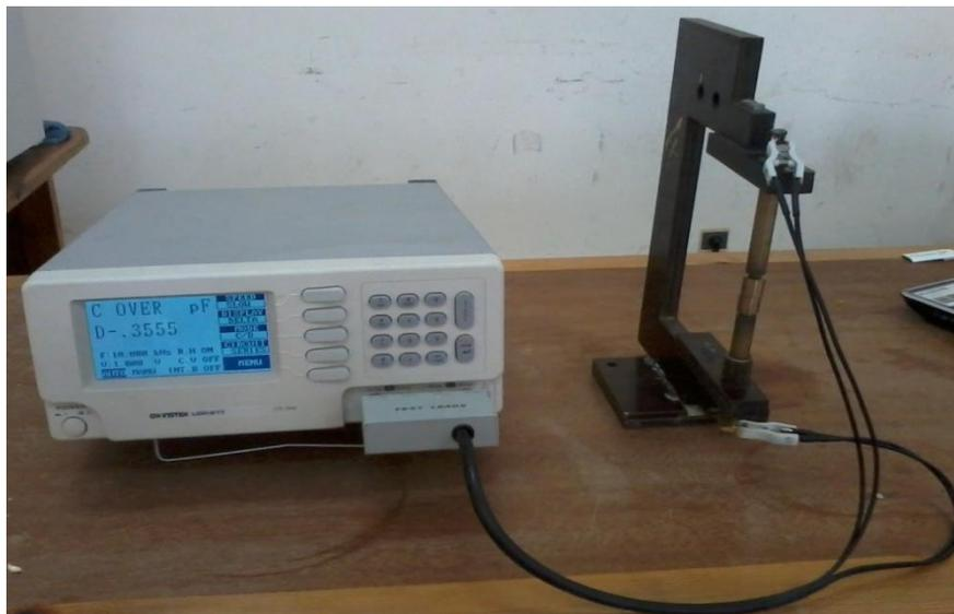
**Figure III.9.** Montage expérimental utilisé pour la caractérisation diélectrique.
