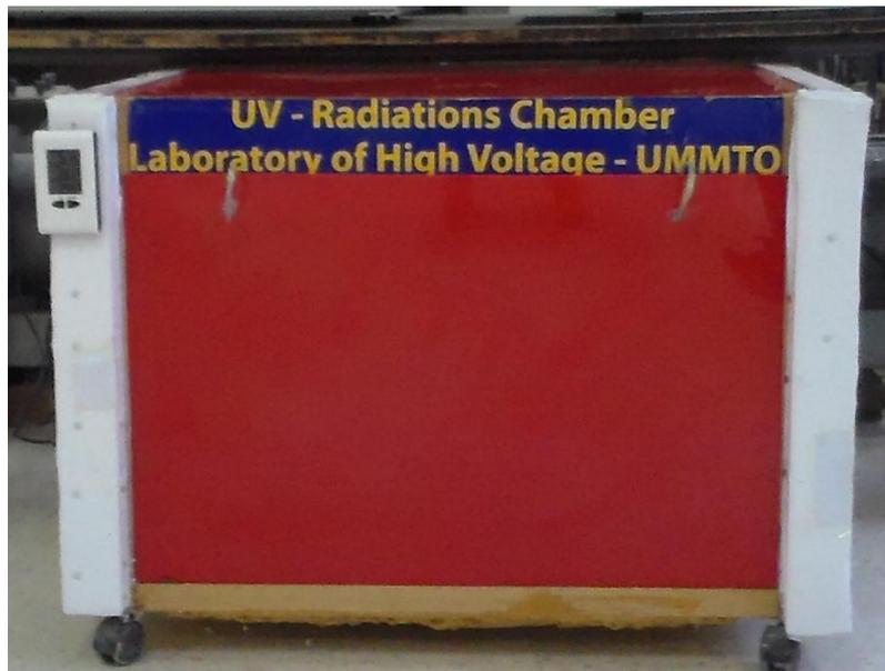
Figure III.7. Vue de la chambre de vieillissement sous UV.
