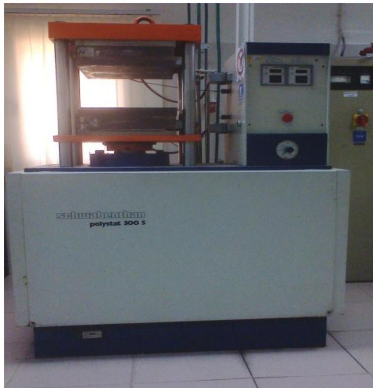
**Figure III.2.** Vue de la presse utilisée pour la fabrication des plaques de PRC.
