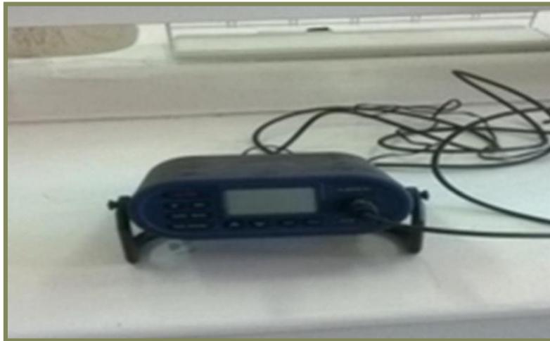
Conductimètre de type W.T.W.Cond 1970i
