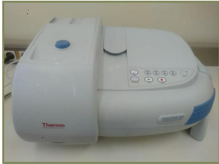
Spectromètre UV-Visible Thermo Scientifique 64606/SDMM/1
