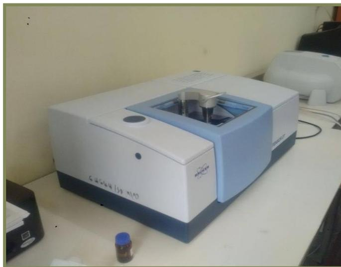
Spectromètre Infrarouge JASCO FT/IR-4200 type A
