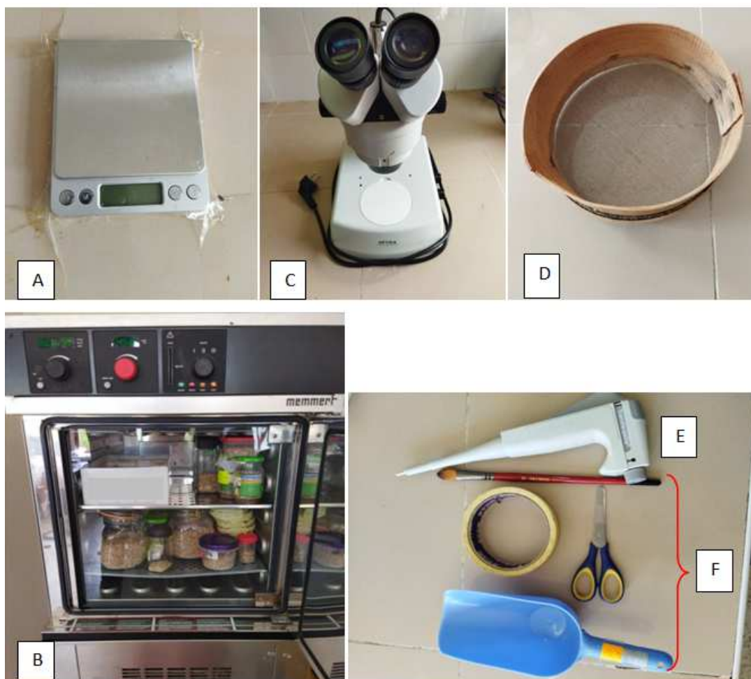
Figure 10: Matériels du laboratoire : (A) balance, (B) étuve réfrigérée, (C) Loupe binoculaire, (D) tamis, (E) Micropipette et (F) autres accessoires (Originale, 2021).
