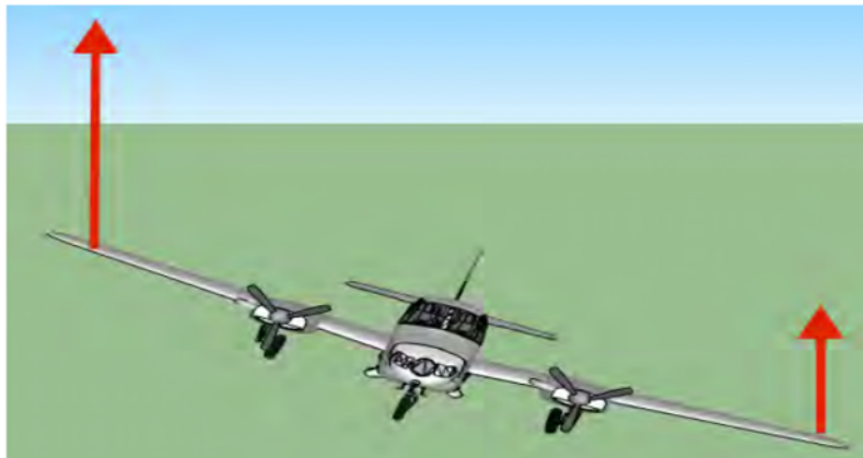
Figure I.5. Conséquences des ailerons sur la force de portance
