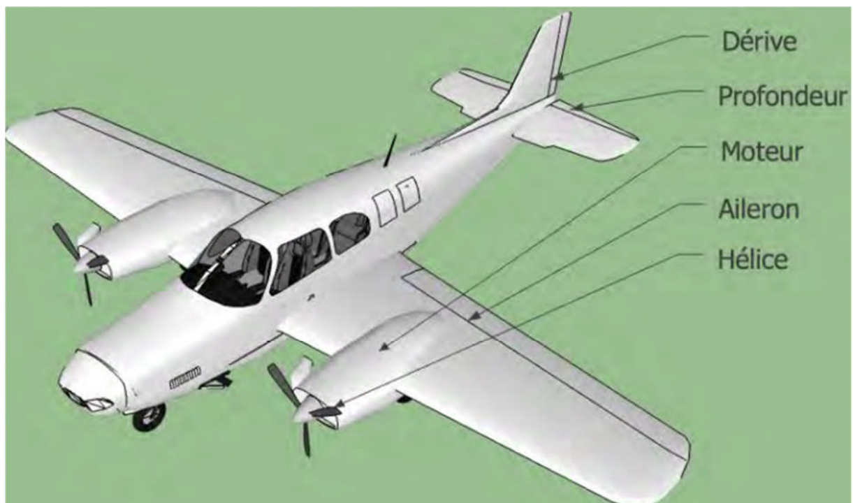
Figure I.1. Avion RC avec ses différentes parties
