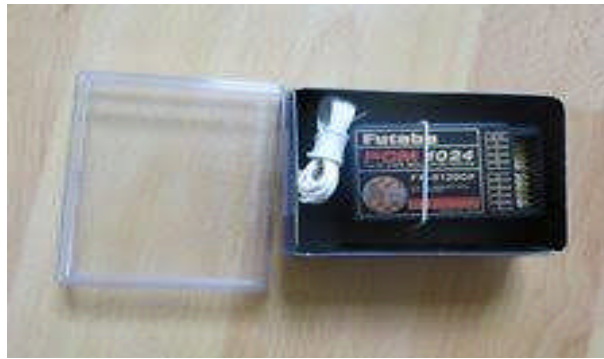
Figure 1.28 : Récepteur RC PCM de type Futaba
