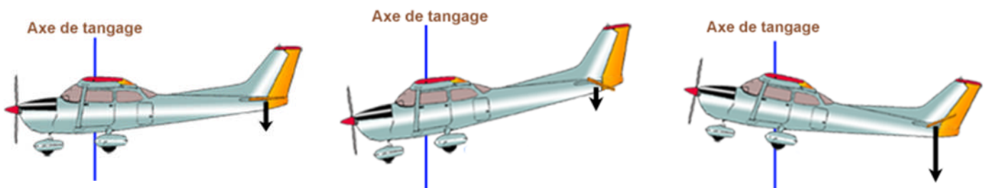
Figure II.5. Mouvement selon l'axe de tangage
