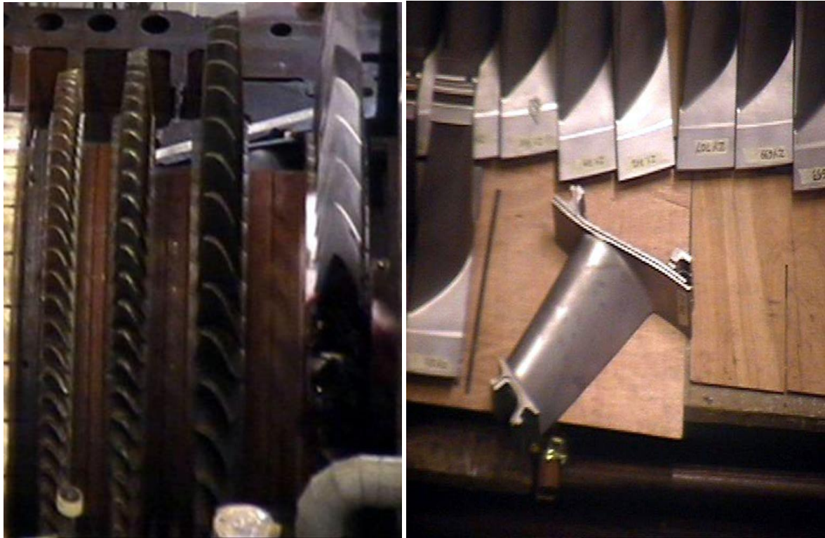
Figure 30: Etages d'aubes de la turbine V94.3A.
