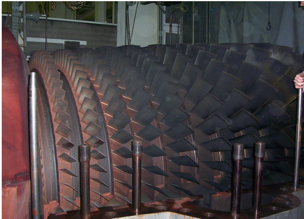
Figure 26: compresseur à 17 étages de la turbine V94.3A.
