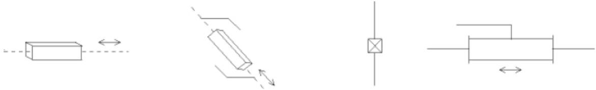
Figure I.3 Symbole de l'articulation prismatique [3].
