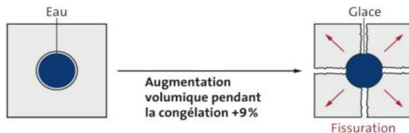
Figure 1.5 : Effet du gel de l'eau sur le béton [42]
