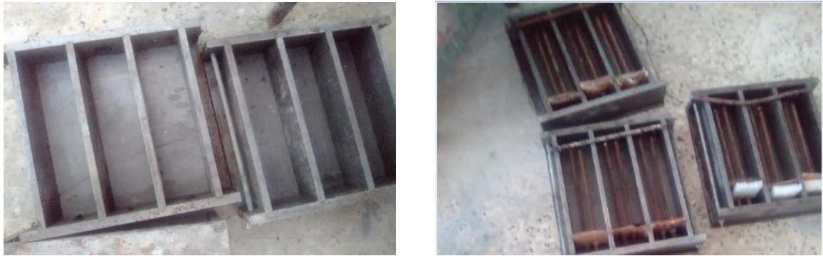
Figure 2.6: Préparation des Moules pour éprouvette en béton et béton armé
