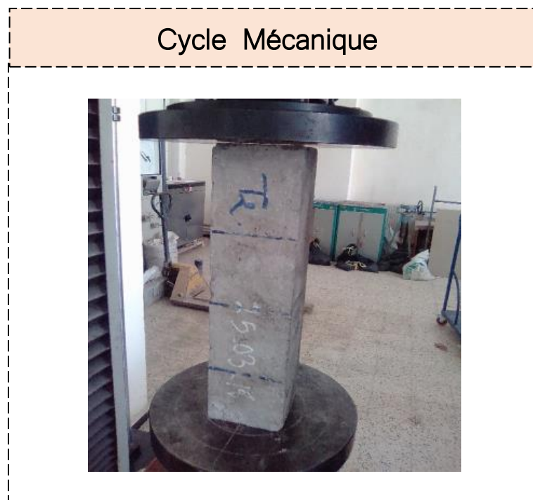
Figure 2.14: Image du dispositif d'application aux éprouvettes du cycle mécanique statique en compression axiale : Chargement-Déchargement.
