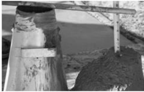
Figure 2.8: Essai de consistance au cône d'Abrams
