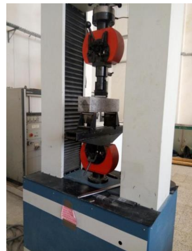
b) dispositif d'essai de flexion
