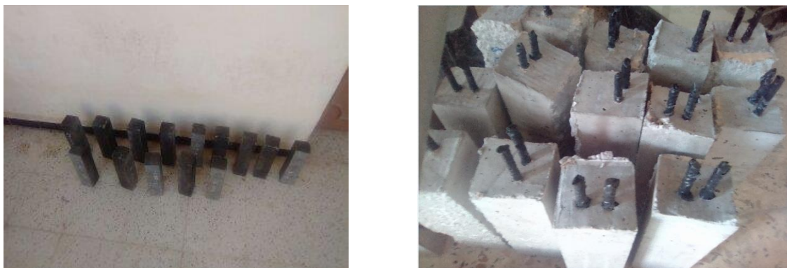
Figure 2.7: Confection des éprouvettes utilisées dans cette étude. 7x7x28 en béton et en béton armé
