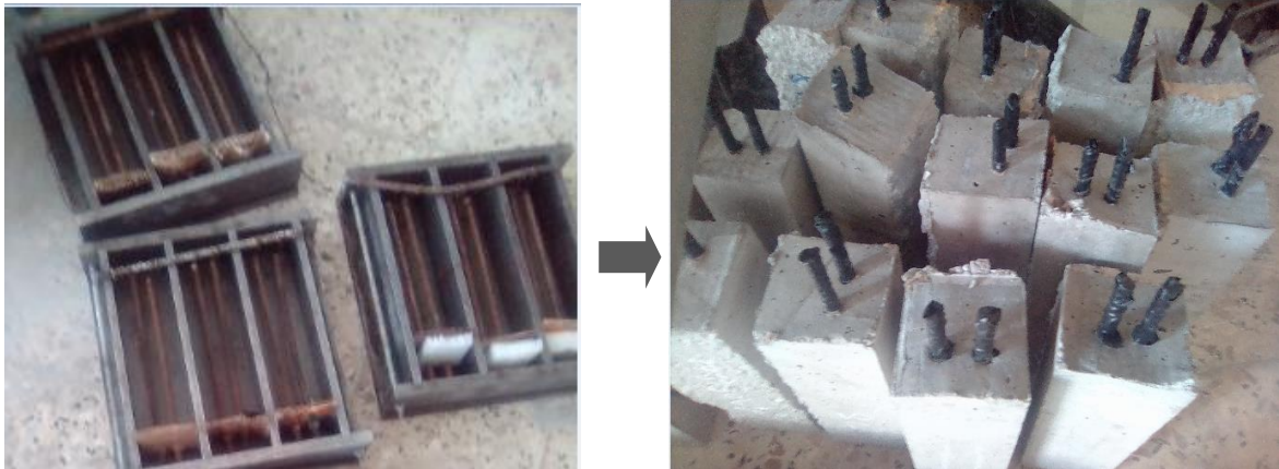
Figure 3.2 : Dispositif de confection des éprouvettes utilisées.
