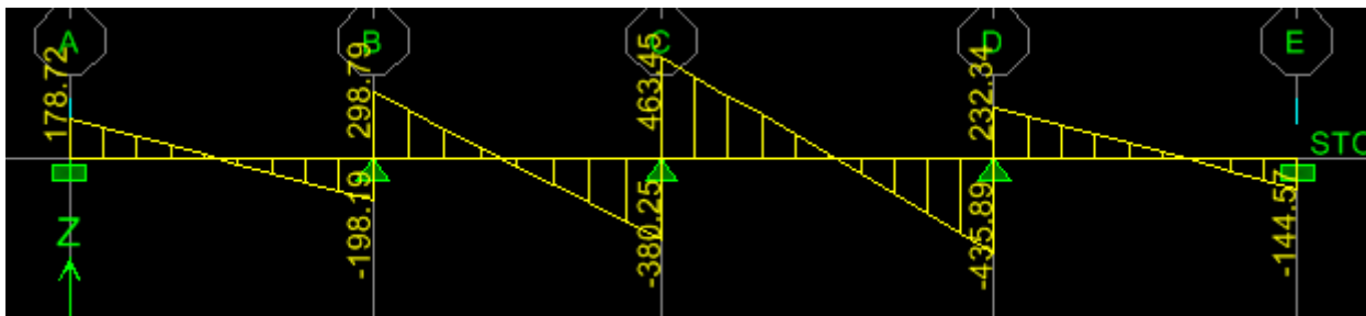
Figure 7.22 : Diagramme des efforts tranchants à ELS en KN.
