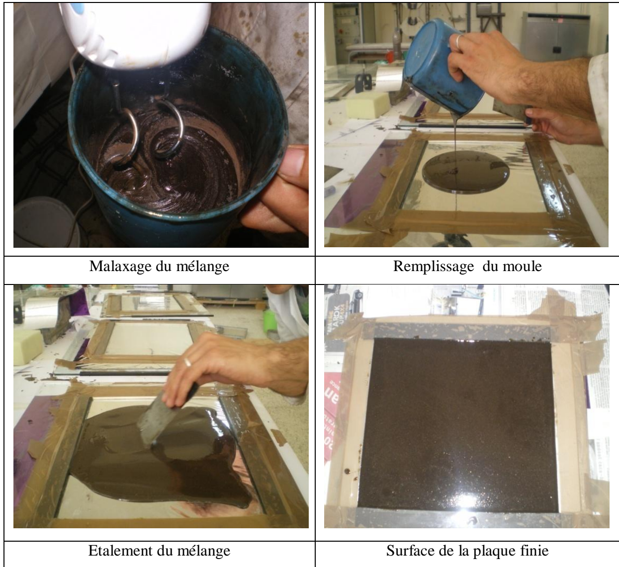
Figure 4.2.18 : Principales étapes d'élaboration des éprouvettes
