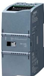
SIMATIC S7-1200, entrée analogique, SM 1231, 4 AI, +/-10 V, +/-5 V, +/-2.5V, ou 0-20mA/4-20mA, 12 bits+signe (13 bits ADC)
