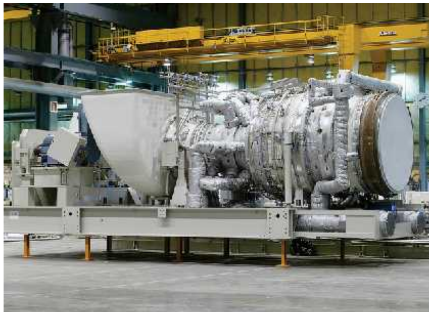
Figure 5 : Turbine à gaz SIEMENS SGT-800.
