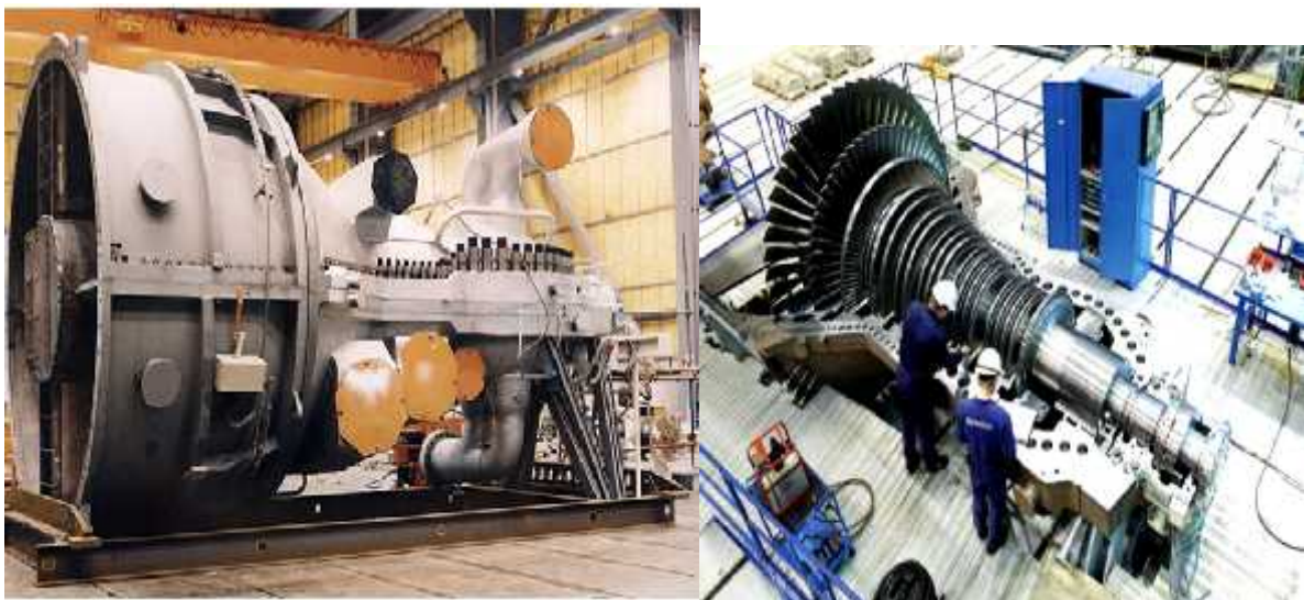
Figure 6 : Image réelle de la TAV SIEMENS SST-900
