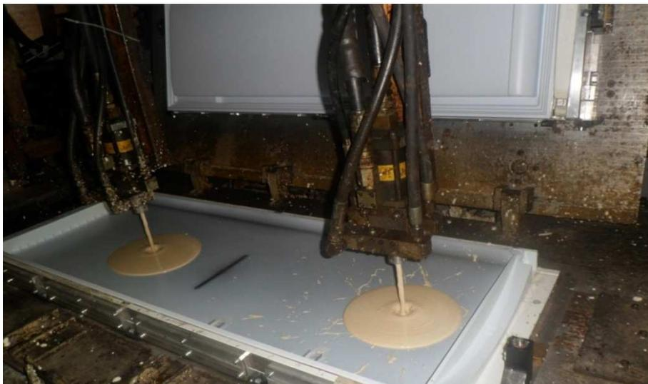
Figure IV.13. Tête d'injection de la mousse (utilisée à l'ENIEM)
