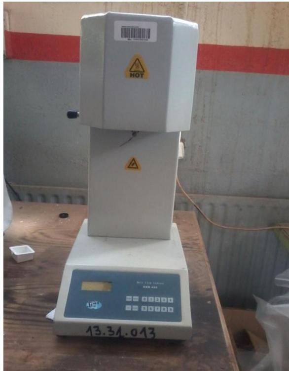
Figure II.1. Machine indice de Fluidité (MFI) utilisé à ENIEM (LABO)
