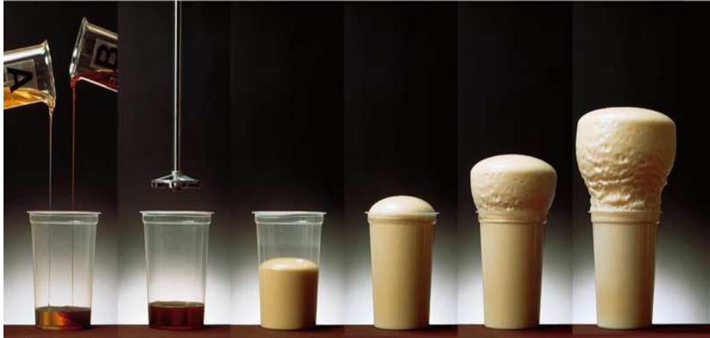
Figure. IV.10 : Formation de la mousse polyuréthane
