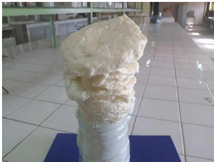
**Figure. IV. 4 : Expansion libre de la mousse polyuréthane**
