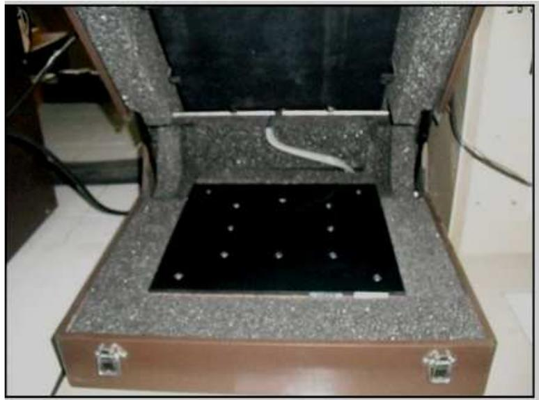
Figure IV.17 .L'appareil de mesure de la conductivité thermique utilisé à l'ENIEM
