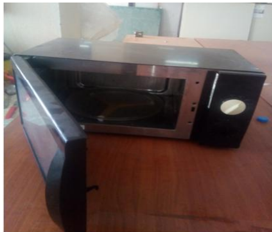
Figure III.9 Micro onde utilisé pour la dévulcanisation de la poudre de caoutchouc
