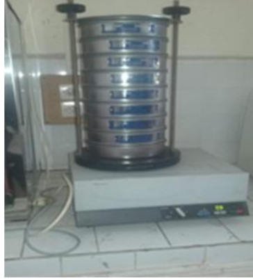
Figure III.8: Les tamis utilisés pour séparer la poudre de caoutchouc en différentes granulométrie
