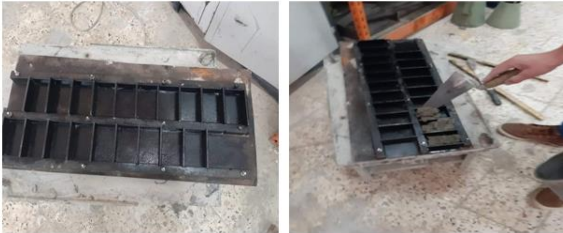
Figure III. 10 : Coulage des éprouvettes.
