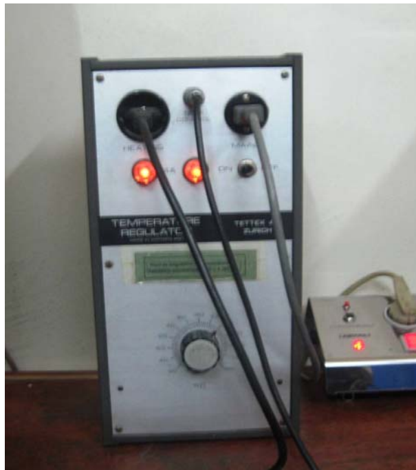
Figure III-11 : Régulateur de température du type 2965
