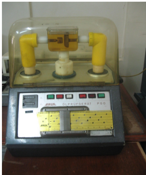
Figure III.14 : Spintermètre automatique du type BAUR OLPROFGERAT PGA 90A.
