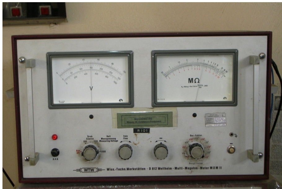
Figure III.12 : Mégohmmètre du type MULTI MEGOHM METER MOM 11
