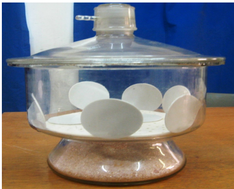
Figure III.6 : Dessiccateur et échantillons durant le conditionnement.
