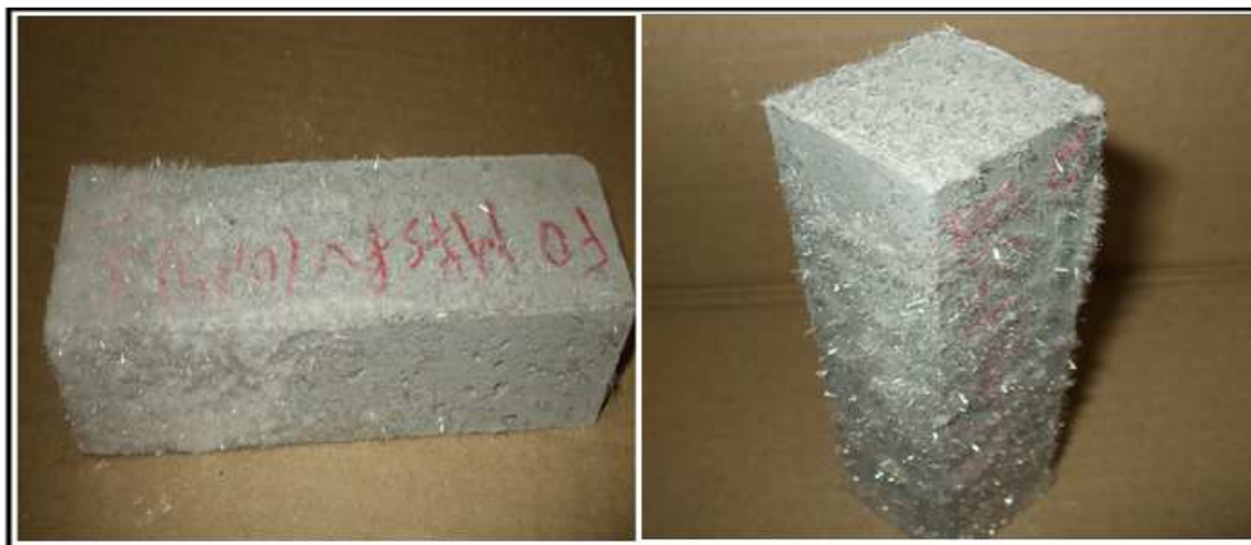
Figure 5.24 : Éprouvettes conservées dans le sulfate d'ammonium.
