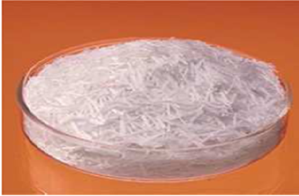
Figure 1.8: Les fibres de verre [50].
