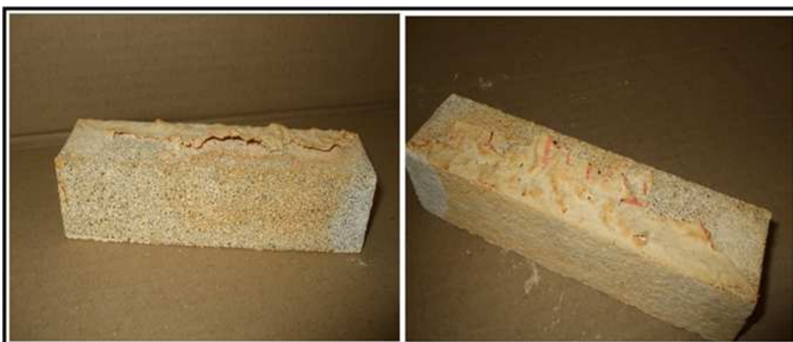
Figure 5.25 : Éprouvettes conservées dans l'acide sulfurique.
