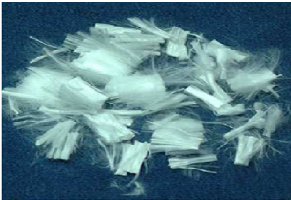
Figure 1.7 : Les fibres de polypropylène [50].
