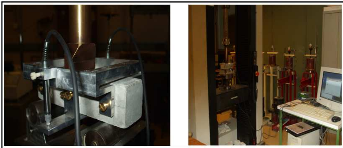
Figure 3.10 : Capteurs LVDT utilisés pour la lecture des déplacements en flexion 3 points et le système d'acquisition des données.
