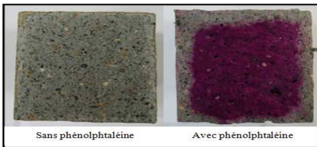
Figure 3.14 : A gauche : surface sans la phénolphthaléine, à droite surface imbibée de la phénolphthaléine.
