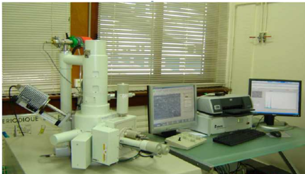
Figure 3.15 : Appareil du MEB au laboratoire.
