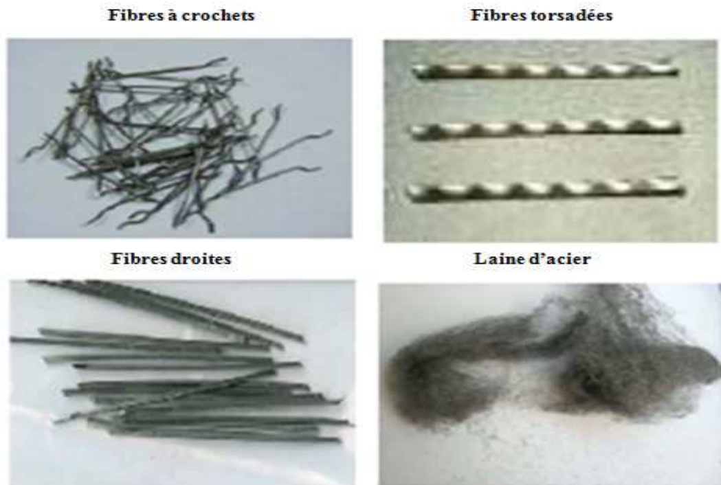
Figure 1.9: Différents types de fibres d'acier [52].
