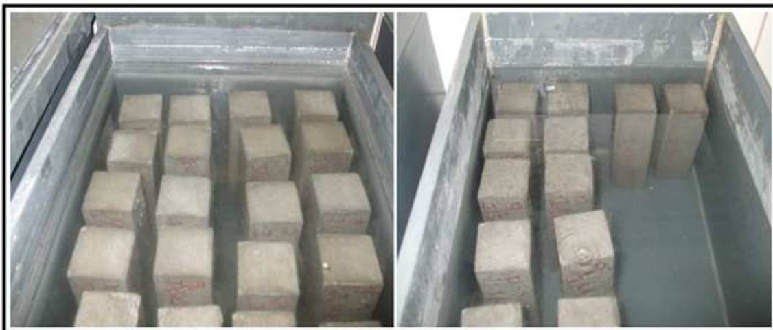
Figure 5.23 : Conservation des éprouvettes dans les solutions acides.
