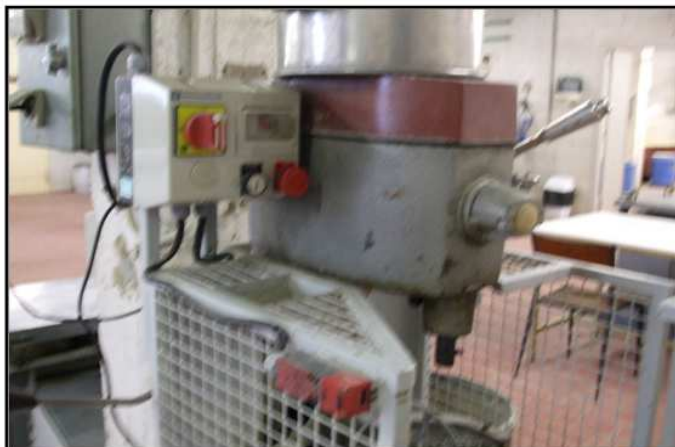
Figure 3.8 : Malaxeur utilisé pour la confection des éprouvettes.
