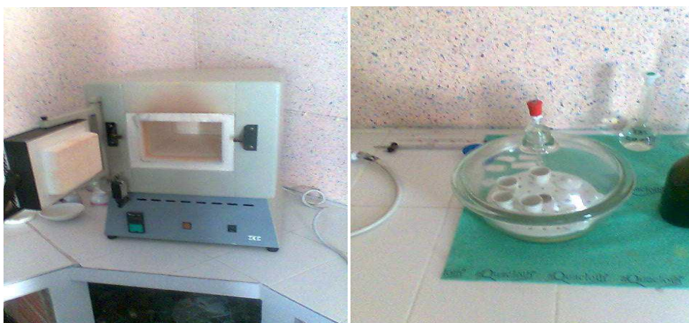
Figure 16 : Détermination de la teneur pondérale en matières organiques.
