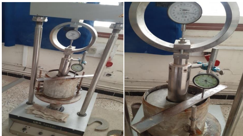
Figure III.19 : Exécution de l'essai CBR après immersion.
