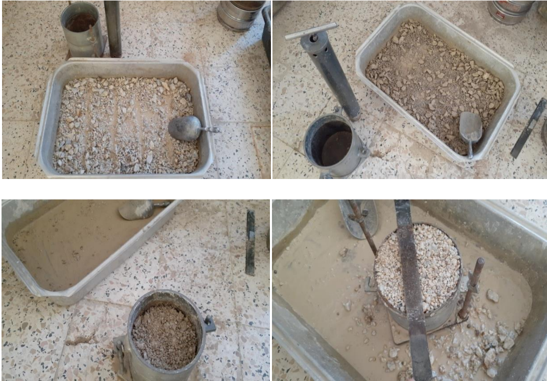
Figure III.9. Exécution de l'essai Proctor modifié.
