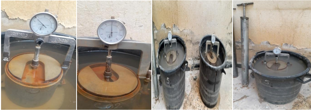
Figure III.18 : Phase d'imbibition et mesure du gonflement à l'immersion.
