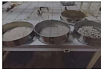
Forme des agrégats après 2 h d'essai (tamisat et refus sur le tamis de 1.6 mm)
