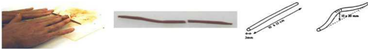
Figure 14 : Etape de la limite de plasticité.
