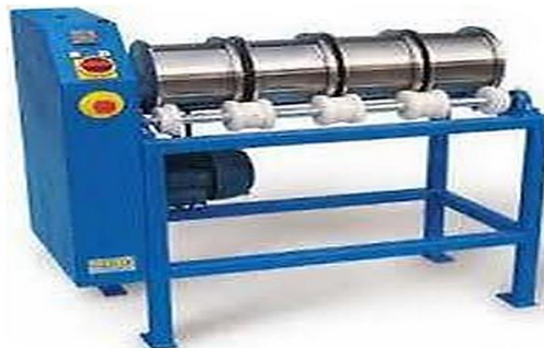
Figure V.1 : L'appareil Micro Deval.
