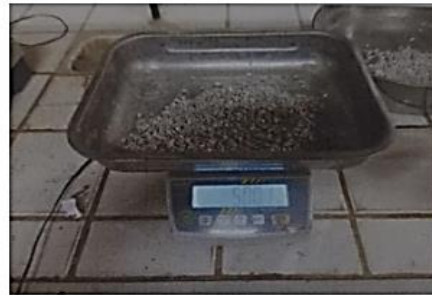
Peser 500 gr des agrégats sous essai
