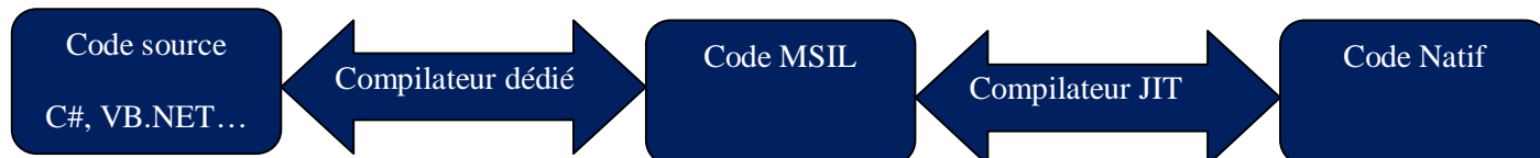
Figure 2 : processus de compilation d'un code écrit par un langage .NET
