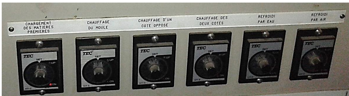
Figure III.9. Le tableau de commandes des temps des étapes du procédé.
