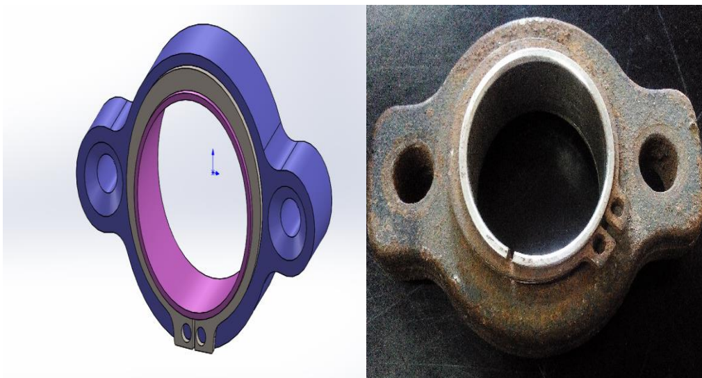
Figure III.26. Une bride conçue par SolidWorks, et une bride réelle.
