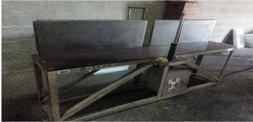
Figure II.20. Résistance industriel pour la découpe du PSE-M utilisée par l'ENIEM.
