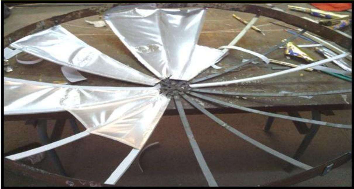
**Figure V-3 : Mise en place des triangles en aluminium sur le squelette**
