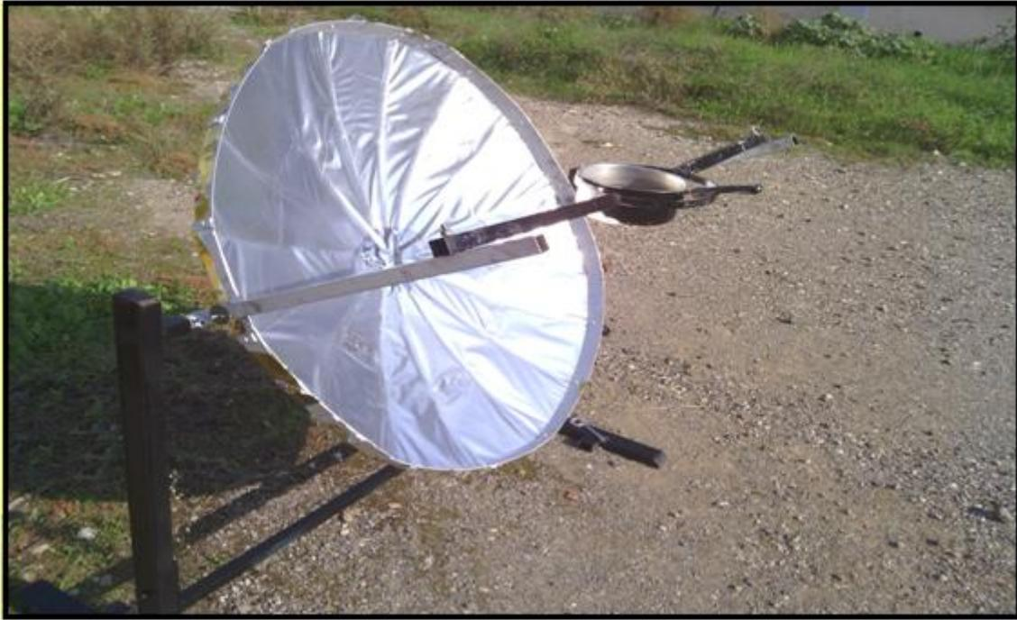
Figure V-7 : chauffage d'un litre d'eau avec le concentrateur réalisé
