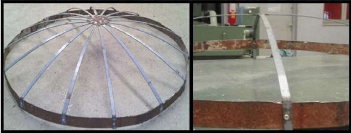
**Figure V-1 : le squelette de la parabole**
