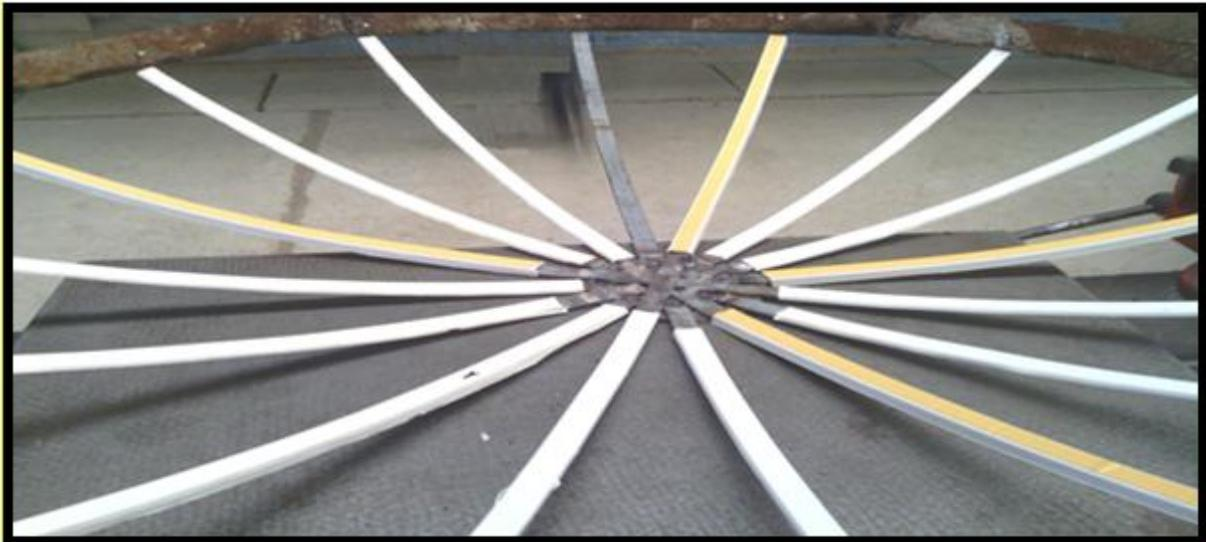
**Figure V-2 : Mise en place des baguettes en plastique sur le squelette**
