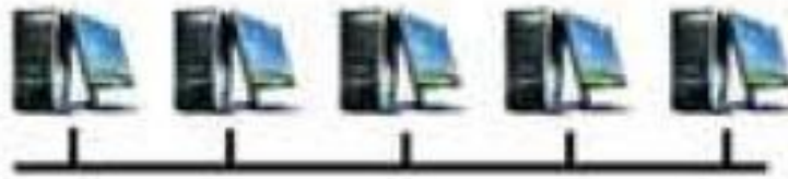
Figure2 : Topologie en BUS
