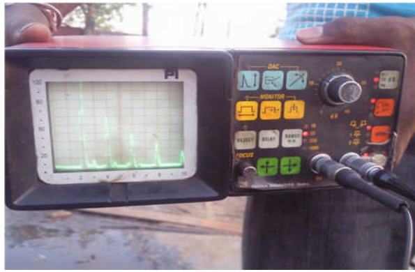
Figure I.7 : Equipement de contrôle par ultrasons. Les ondes émises et réfléchies donnent des informations sur la présence ou l'absence de défauts et leurs natures.
