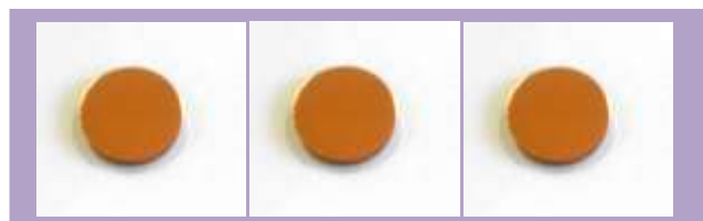
Figure II.2: Photographie des pastilles de cuivre utilisées pour le dépôt des nanoparticules de bismuth.
