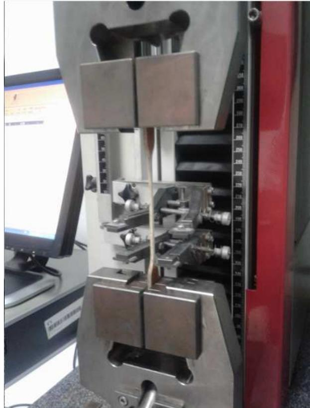
**Figure IV.13: Machine de traction de la marque ZWICK de type BTC-FR 2.5TN.D09 (ORIGINALE, 2018).**
