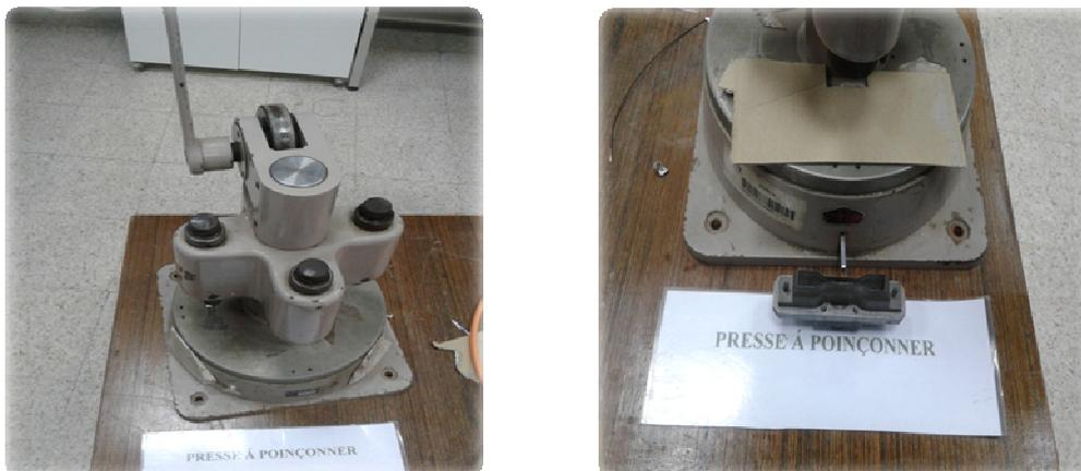
**Figure IV.1 : Presse à poinçonne
